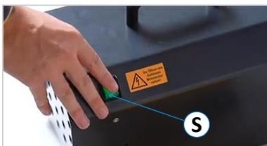
Abbildung 11: Vakuumpumpen-Schalter
