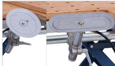
Abbildung 9: Vakuumsauggreifer
