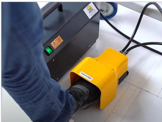
Abbildung 18: Fußschalter zum Lösen
