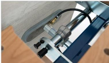
Abbildung 8: Vakuumspanneinheit
