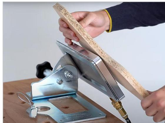
Abbildung 19: Werkstück entnehmen
