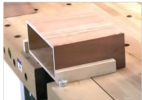
Abbildung 13: Spannen mit Zwischenstücken
