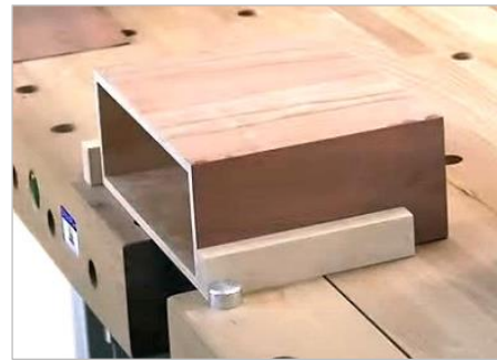
Figure 13: serrage avec pièces intermédiaires
