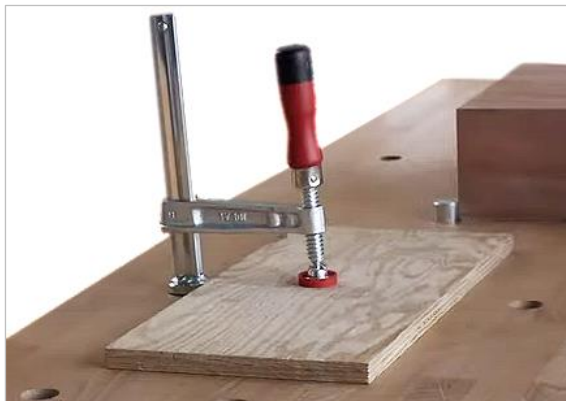
Figure 14 : exemples d'applications pour les serre-joints verticaux
