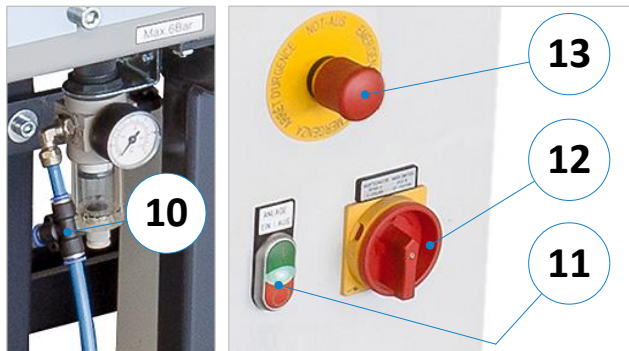
Figure 10 : interrupteurs et raccord d'air comprimé
