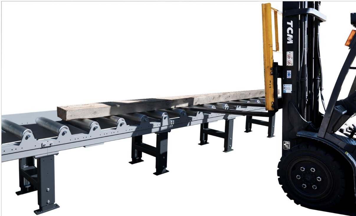
Abbildung 21: Beladen der EXAKT HD Rollenbahn mit einem Gabelstapler
