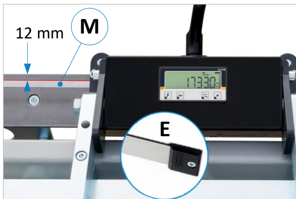
Abbildung 15: Magnetband Montage bei EXAKT E/KF
