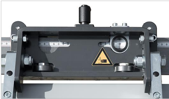
Figure 12 : alignement du ruban de mesure EXAKT MES B/KF
