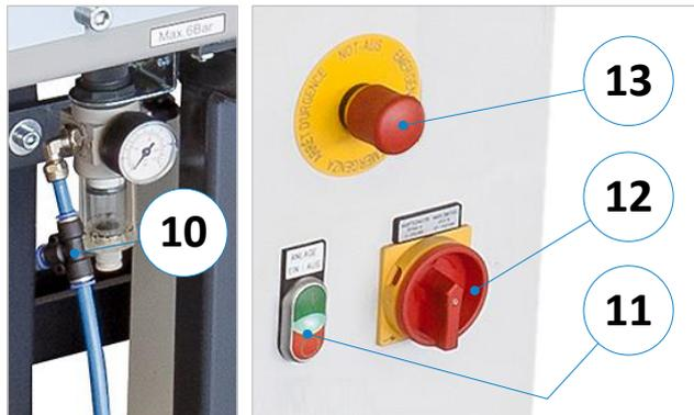
Abbildung 10: Bedienschalter und Druckluftanschluss
