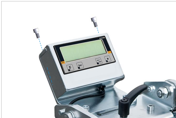
Figure 13 : remplacement de la pile IZ17E - Ouvrir le boîtier
