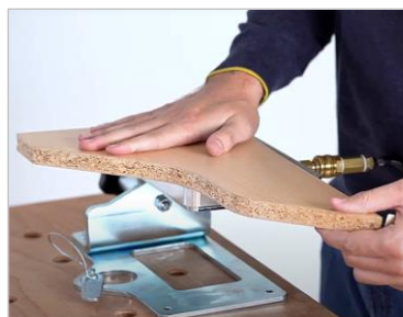
Figure 16 : poser la pièce à usiner
