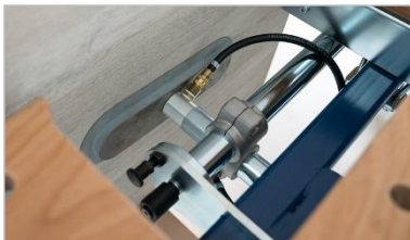
Figure 9 : unité de serrage par le vide
