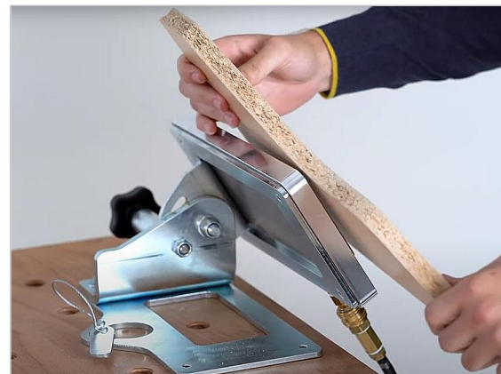
Figure 20 : retirer la pièce à usiner
