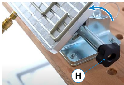
Figure 18 : pivoter le plateau de serrage
