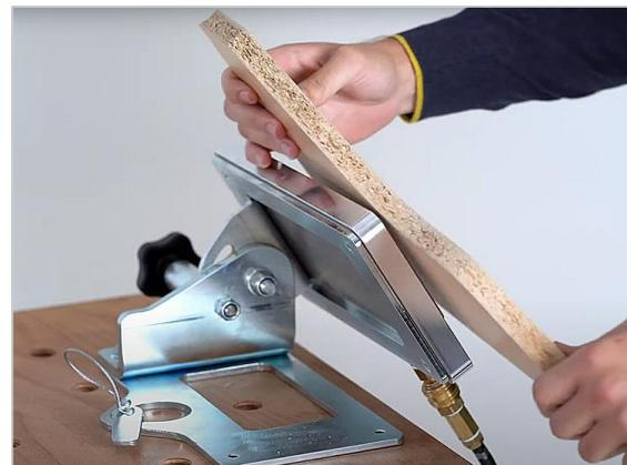
Abbildung 20: Werkstück entnehmen
