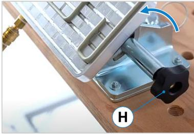
Abbildung 18: Spannplatte schwenken
