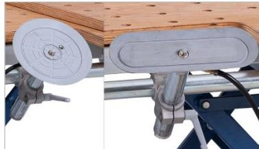
Abbildung 10: Vakuumsauggreifer
