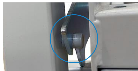
Figure 10: le cadre pivotant est enclenché verticalement
