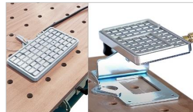
Figure 11 : plaques de serrage
