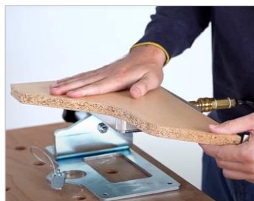
Figure 16 : poser la pièce à usiner
