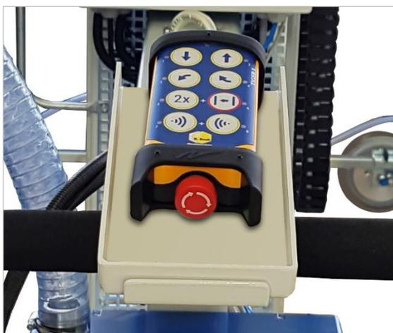
Abbildung 9: Ablagefach direkt an der Schiebestange
