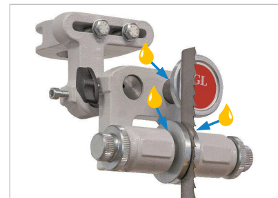
Figure 52 : huiler les galets de guidage GL
