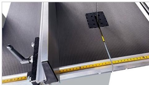
Figure 43 : ruban de mesure sur la table
