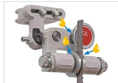
Figure 52 : huiler les galets de guidage GL
