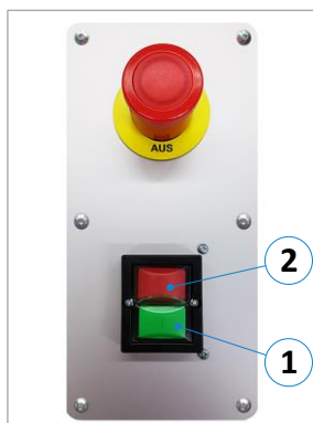
Figure 19 : commande par bouton poussoir 1,1 à 1,5 kW
