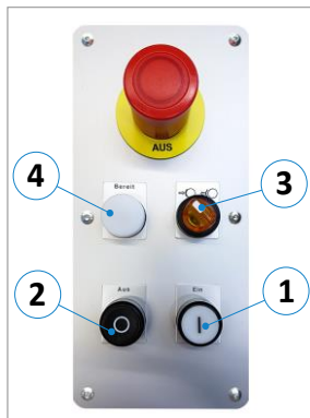
Figure 18 : commande par bouton poussoir 3,0 à 3,5 kW
