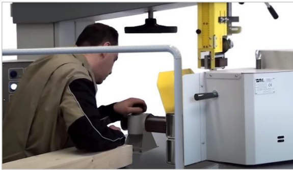
Abbildung 84: Schnittmaß am Rollenanschlag einstellen
