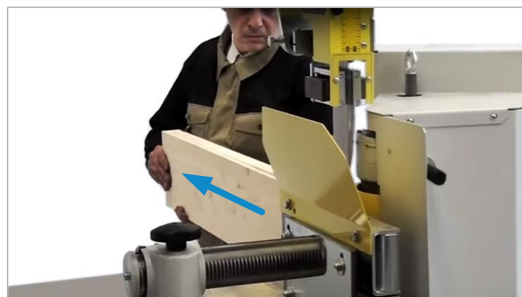
Abbildung 89: Werkstückteile abnahmeseitig entnehmen
