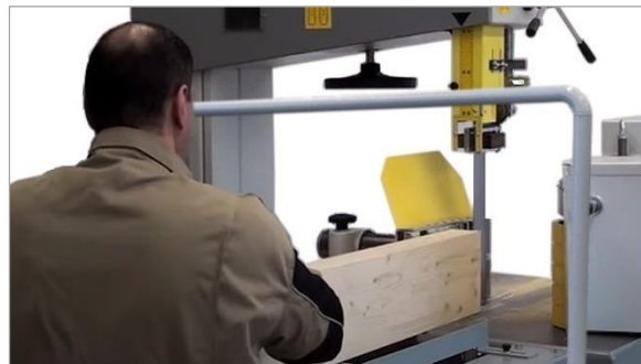
Abbildung 87: Werkstück auflegen und zum Anschlag führen
