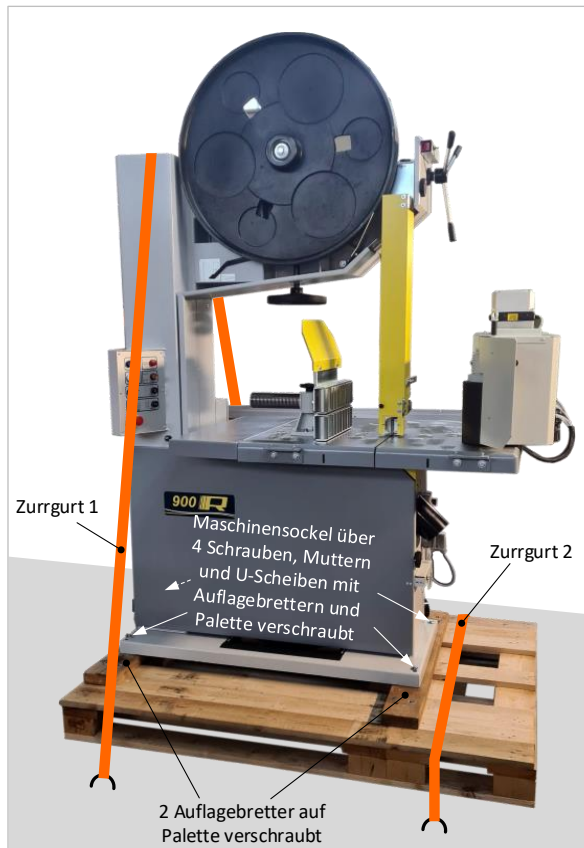
Abbildung 12: Maschine auf Palette verzurren
