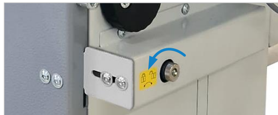
Abbildung 45: Sicherheitsschalter - Türe verriegelt
