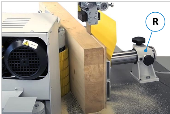
Abbildung 70: Rollenanschlag und Vorschub im Einsatz
