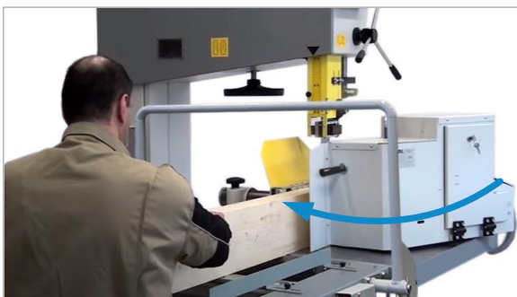
Abbildung 88: Vorschubeinheit zur Bearbeitung einrücken
