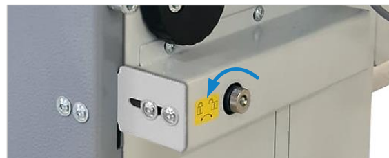
Figure 45 : interrupteur de sécurité - porte verrouillé
