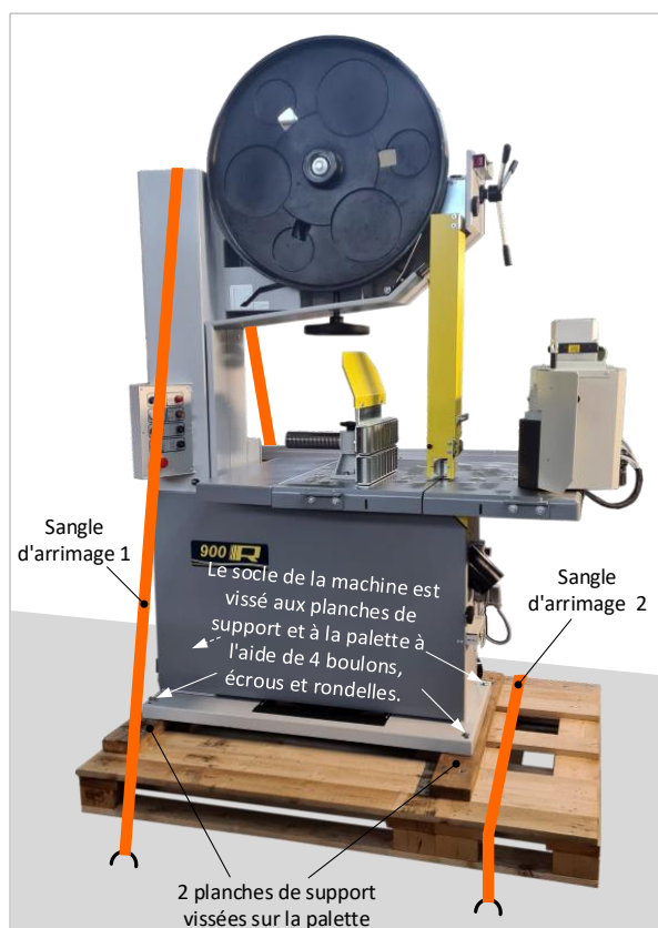
Figure 12 : arrimer la machine sur une palette
