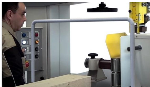
Figure 85 : mettre en marche la scie à ruban et l'avance
