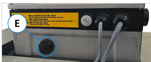
Figure 80 : molette de réglage pour une vitesse variable
