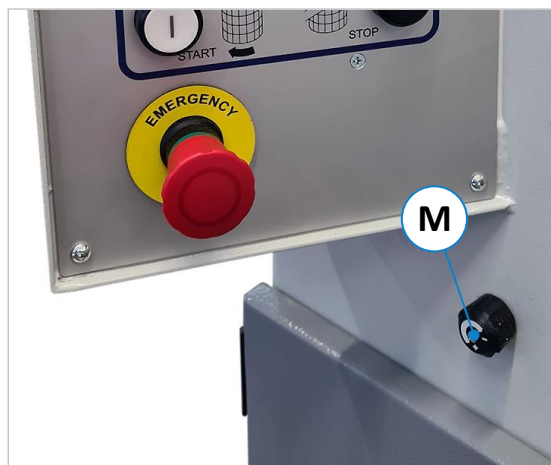
Figure 82 : molette de réglage du débit de lubrifiant
