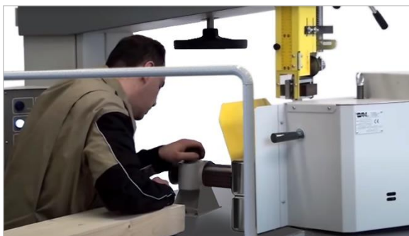
Figure 84 : régler la cote de coupe sur la butée de rouleau
