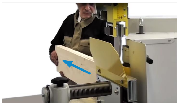
Figure 89 : prélever les pièces à usiner du côté de la sortie
