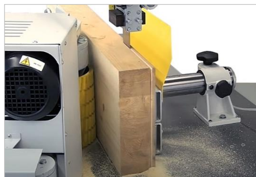
Figure 2 : opération d'usinage à la scie à ruban
