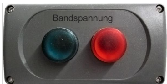
Figure 67 : surveillance de la tension de la lame
