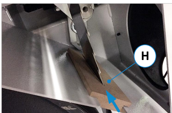
Figure 61 : fixer l'aide à l'aspiration
