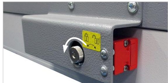
Abbildung 27: Sicherheitsschalter UTK 600 - Türe verriegelt
