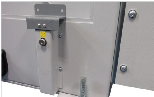
Abbildung 28: Sicherheitsschalter vertikal angeordnet
