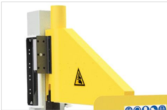
Abbildung 31: Spann-Schutzhaube bei Modell UTK 600
