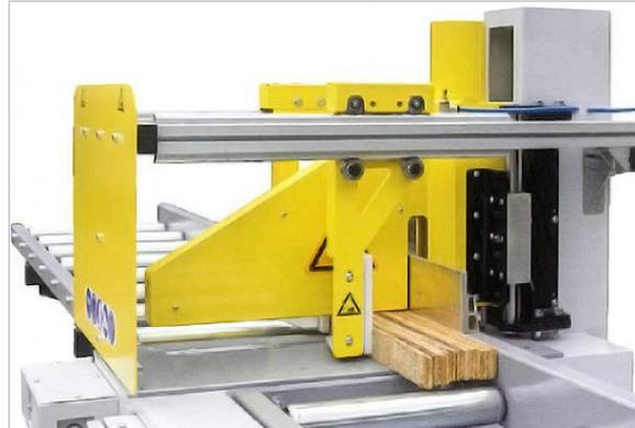
Abbildung 38: Pneumatische Horizontal-Spanneinrichtung
