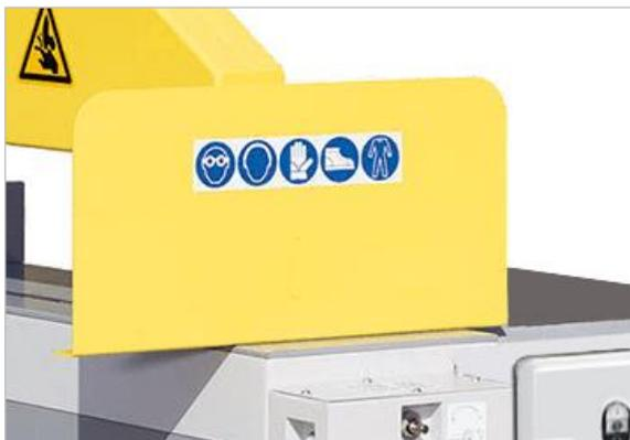
Abbildung 33: Schutzschild bei Standard-Ausführung
