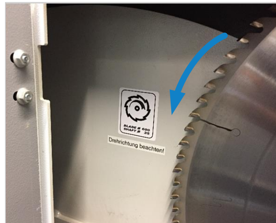
Abbildung 30: Drehrichtung des Kreissägeblattes
