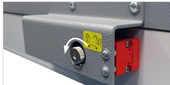
Abbildung 27: Sicherheitsschalter UTK 600 - Türe verriegelt
