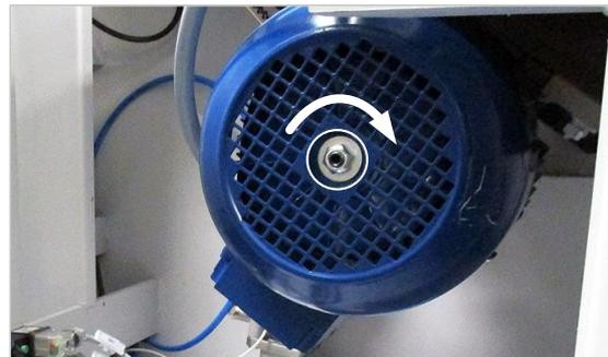
Abbildung 55: Bremsjustierschraube 5,5 / 7,5 kW
