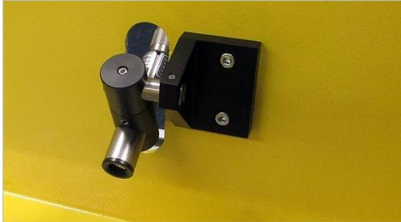
Abbildung 44: Laser-Einheit zur Anzeige der Schnittlinie
