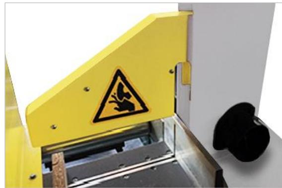
Abbildung 32: Spann-Schutzhaube bei Modell UTK 350
