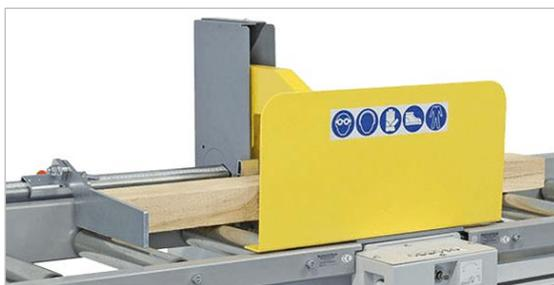
Abbildung 42: Manuelles Anschlag-Positioniersystem
