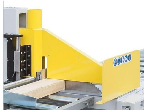
Abbildung 1: Untertischkappsäge im Einsatz
