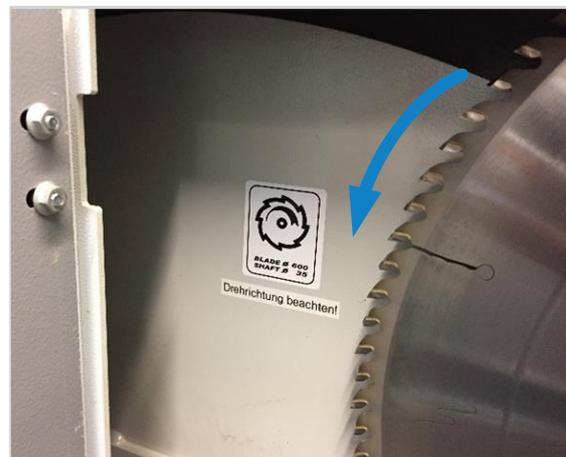
Abbildung 30: Drehrichtung des Kreissägeblattes
