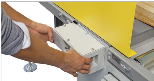
Figure 24 : commande de sécurité bimanuelle
