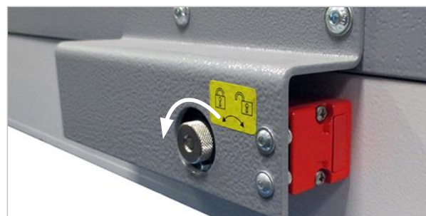
Figure 27 : interrupteur de sécurité - porte verrouillée
