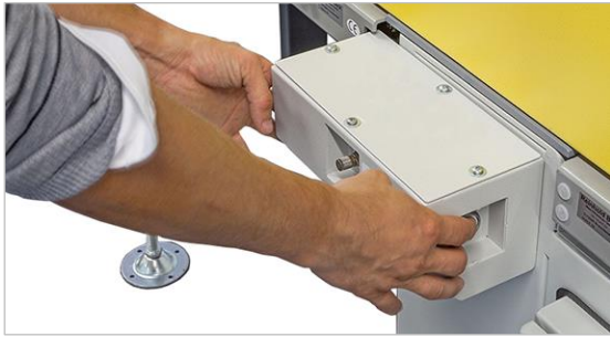
Figure 43 : course de coupe via commande bimanuelle
