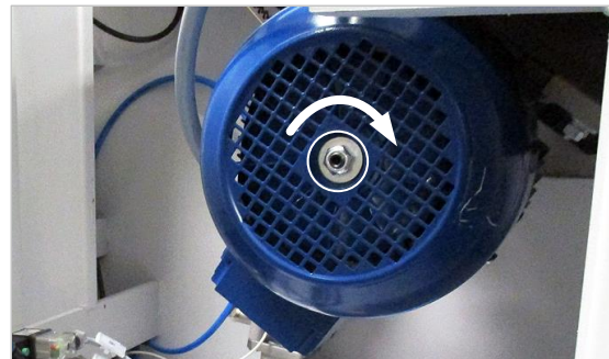
Figure 55 : vis de réglage du frein 5,5 / 7,5 kW
