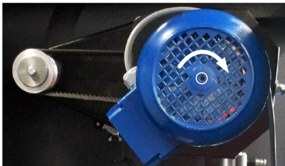
Figure 54 : vis de réglage du frein 2,2 / 3,0 / 4,0 kW
