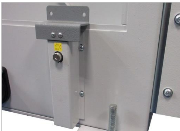
Figure 28 : interrupteur de sécurité placé verticalement
