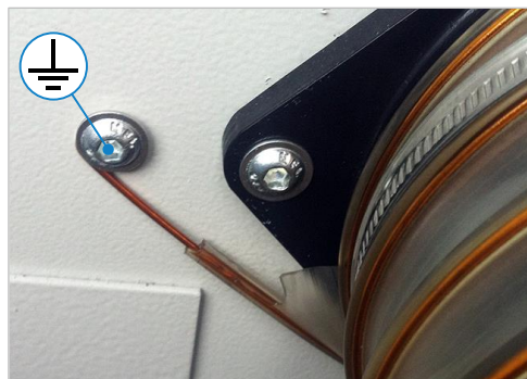
Figure 19 : mise à la terre du tuyau d'aspiration
