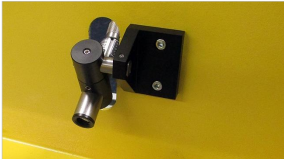
Figure 44 : laser pour indiquer la ligne de coupe
