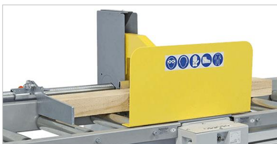
Figure 42 : système de positionnement de butée manuel
