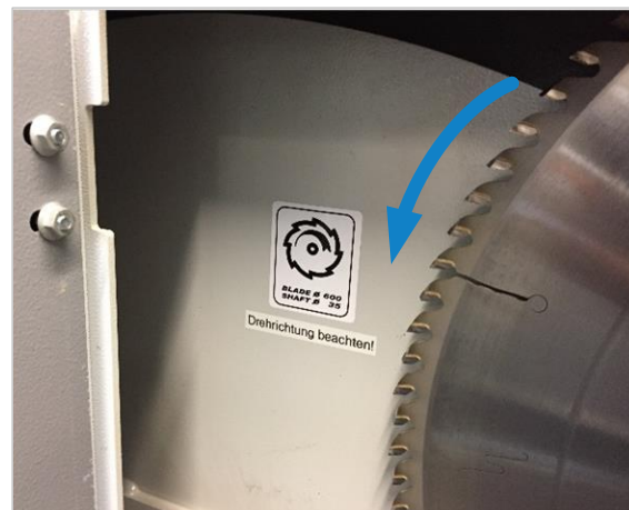
Figure 30 : sens de rotation de la lame de scie circulaire
