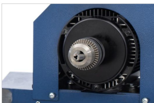
Figure 13 : mandrin de perçage à trois mors
