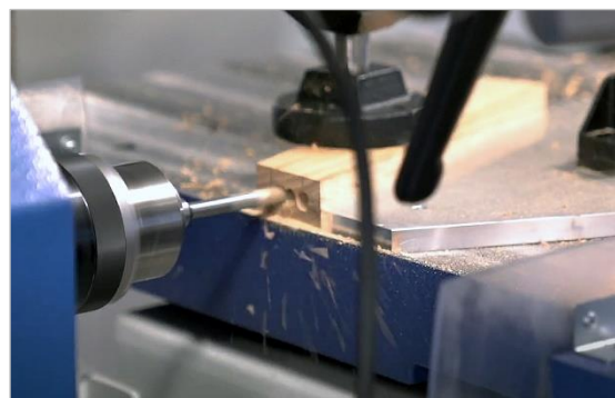
Figure 18 : réaliser un trou oblong
