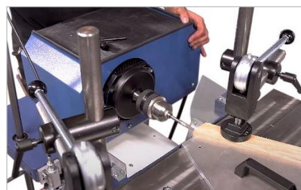
Figure 1 : perçage de trous oblongs
