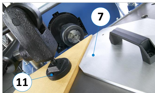
Figuur 16: Klemmen met verstekaanslag
