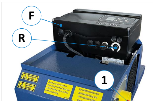
Figuur 29: Traploze snelheid via frequentieomvormer
