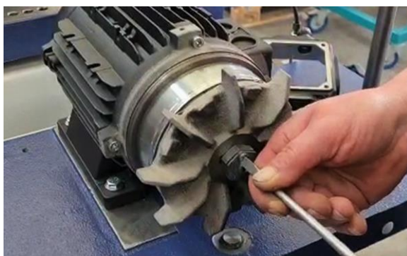
Figuur 40: Draai de borgschroef los
