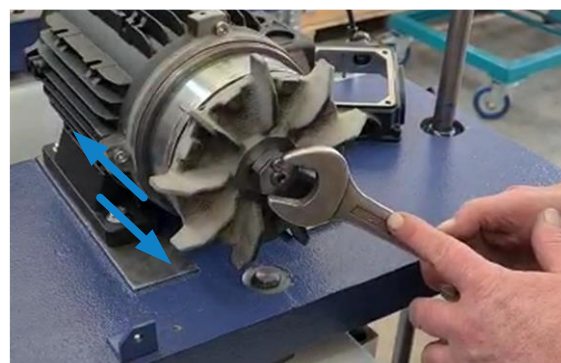
Figuur 41: Stelmoer voor remblokken
