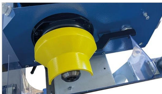
Figuur 30: Elektrisch vergrendelbare beschermkap
