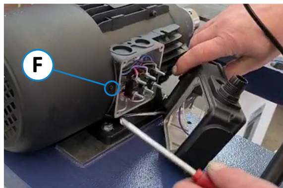
Figuur 39: Aansluitdoos losmaken en verwijderen
