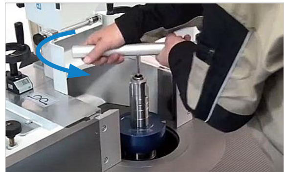
Abbildung 17: Fräsdorn lösen und entnehmen
