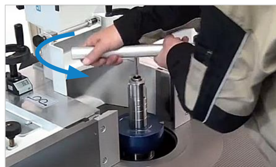
Figure 17 : desserrer et retirer le mandrin de la fraise
