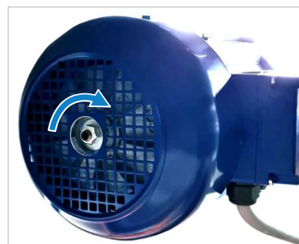
Figure 63 : vis d'ajustement du frein moteur
