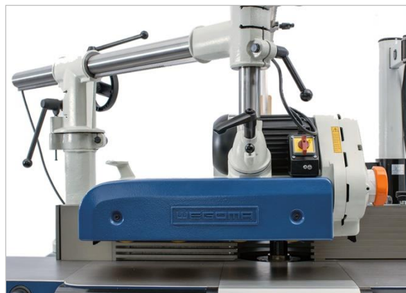
Figure 60 : appareil d'avancement type Variomatic 4N
