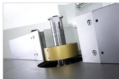
Figure 1 : mandrin avec fraise
