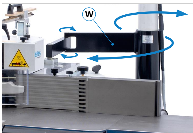
Figure 48 : dispositif de pivotement
