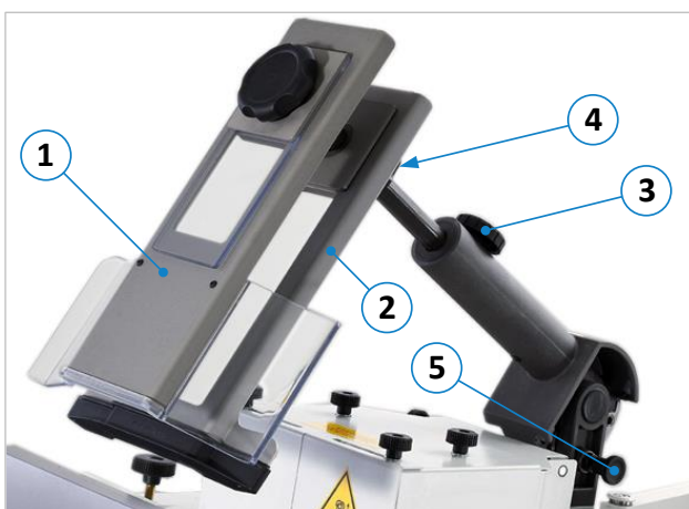
Figure 43 : dispositif de protection et de pression 1624 CENTREX
