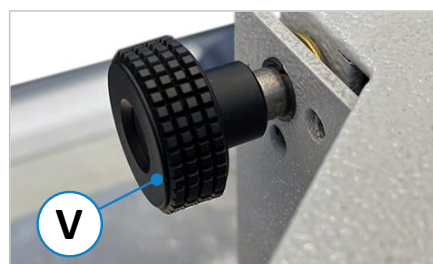
Figure 31 : boulon de verrouillage pour type 302
