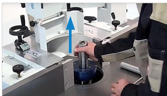
Figure 18 : retirer le mandrin de la fraise
