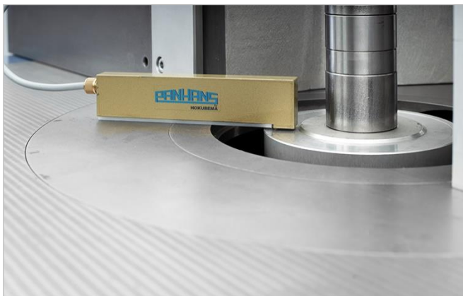
Figure 52 : appareil de calibrage « Zeromaster »
