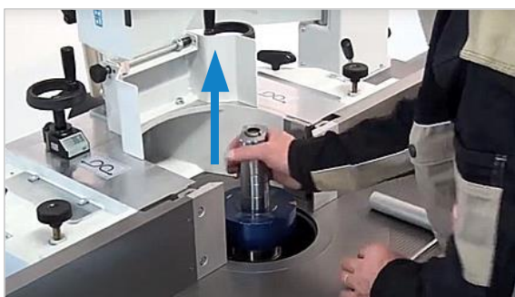
Figure 18 : retirer le mandrin de la fraise
