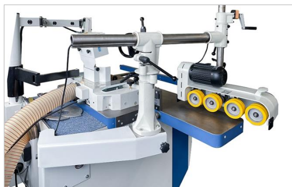
Figure 62 : console de montage pivotante
