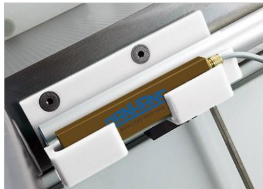
Figur 20: Oppbevaringsrom for spennnøkkelen
