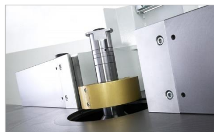
Figur 1: Fresholder med freser
