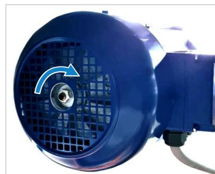
Abbildung 49: Motorbremse Justierschraube
