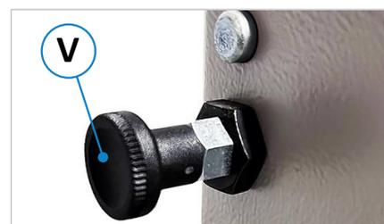
Abbildung 27: Hauben-Verriegelungsbolzen
