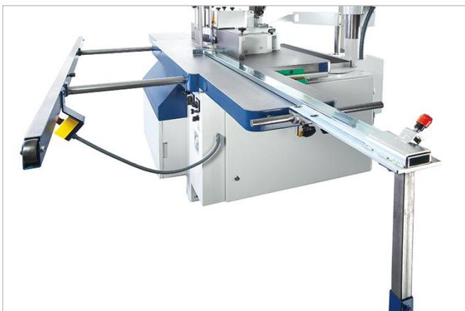
Abbildung 45: Rückschlagschutz Typ 1648
