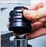
3. Distanzringe (D) abziehen und das neue Fräs Werkzeug aufsetzen.
