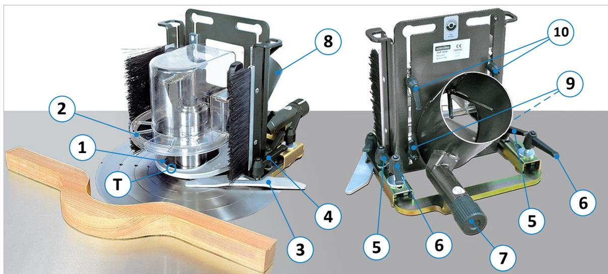
Figure 31 : éléments de commande TAPOA 1639
