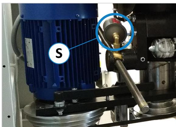
Figure 52 : remplacer le graisseur automatique
