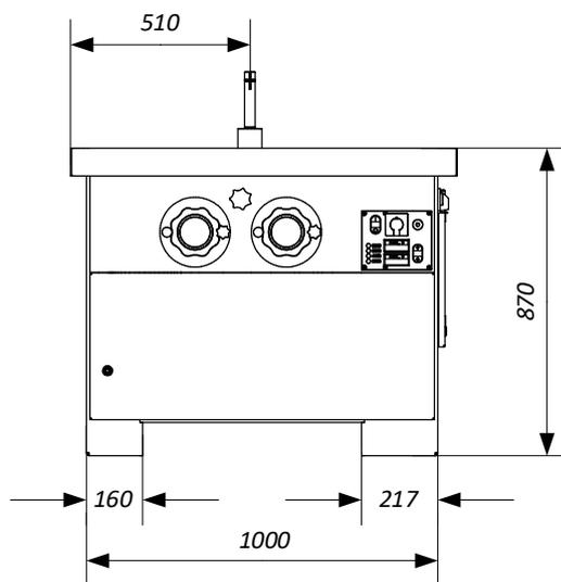
Figure 3 : dimensions - vue de face
