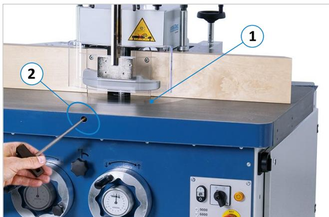
Figure 39 : plateau tournant et ouverture pour le serrage
