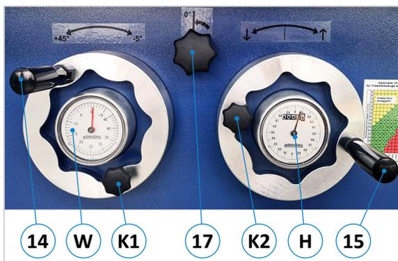
Figure 20 : manivelles pour le réglage de la broche
