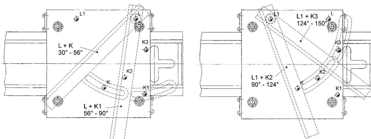
Figure 43 : zones angulaires (position des vis)
