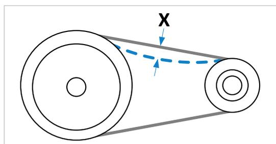
Figure 51 : contrôle de la tension de la courroie
