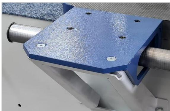
Figure 48 : console rigide pour appareil d'avance
