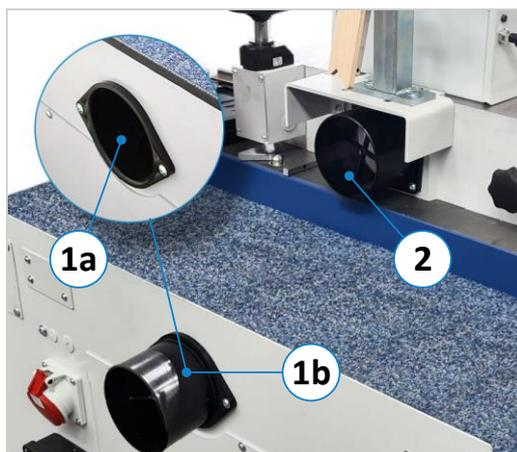
La machine doit être raccordée par le client à un dispositif d'aspiration efficace. Les deux ports d'aspiration (1) et (2) ont chacun un diamètre extérieur de 120 mm.
