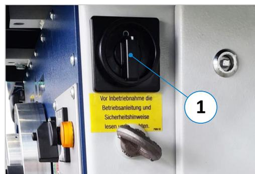
Figure 12 : interrupteur principal
