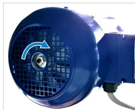
Figure 49 : vis d'ajustement du frein moteur
