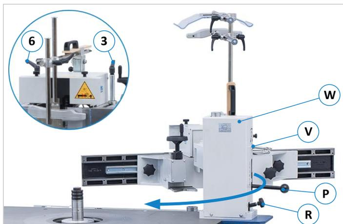
Figure 28 : dispositif de pivotement hydraulique
