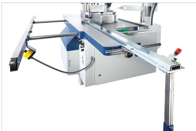
Abbildung 54: Rückschlagschutz Typ 1648
