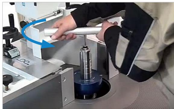
Abbildung 18: Fräsdorn lösen und entnehmen
