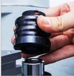
3. Distanzringe (D) abziehen und das neue Fräserwerkzeug aufsetzen.
