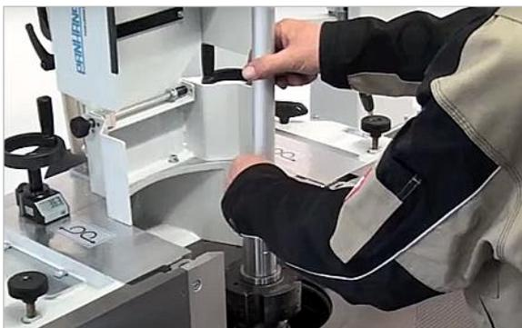
Abbildung 17: Staubschutzkappe entfernen
