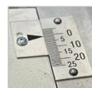
Der Teilanschlag wird am Stellrad (5) verstellt und über eine Nonius-Skala abgelesen.
