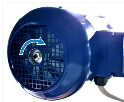
Figure 87 : vis d'ajustement du frein moteur
