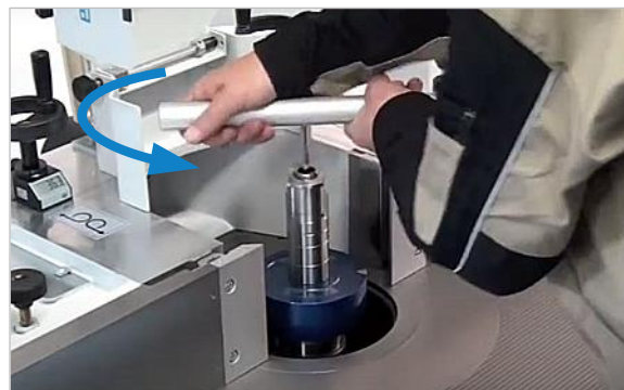
Figure 19 : desserrer et retirer le mandrin de la fraise
