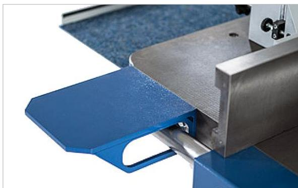
Figure 85 : console de montage fixe
