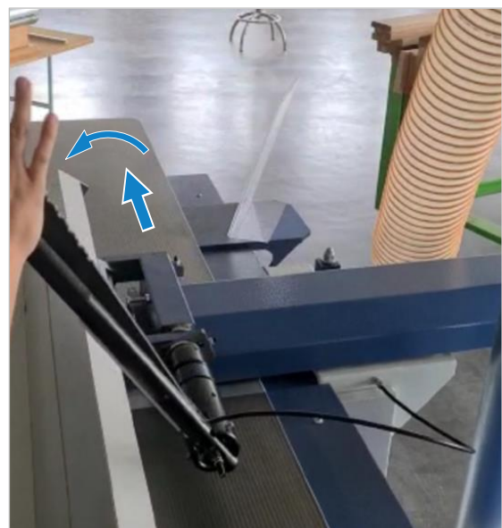
Abbildung 22: Abrichtanschlag Winkel einstellen
