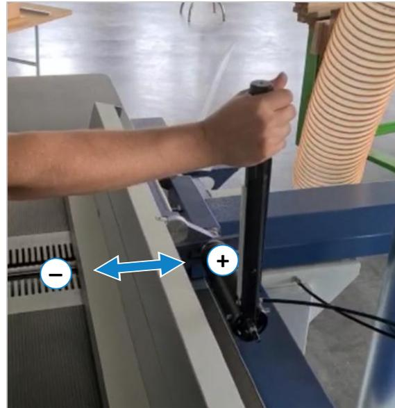
Abbildung 20: Abrichtanschlag linear verstellen
