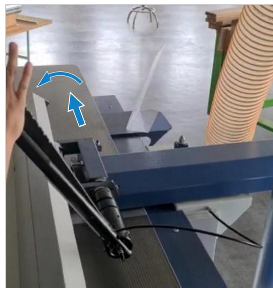
Abbildung 22: Abrichtanschlag Winkel einstellen
