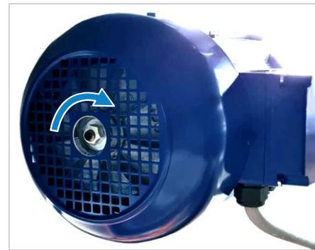
Abbildung 43: Motorbremse nachjustieren
