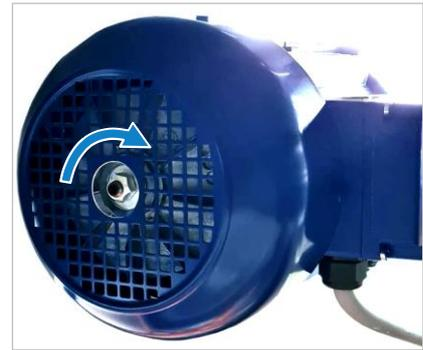
Figure 47 : réajuster le frein moteur
