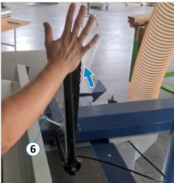
Figure 21 : activer le réglage angulaire de la butée
