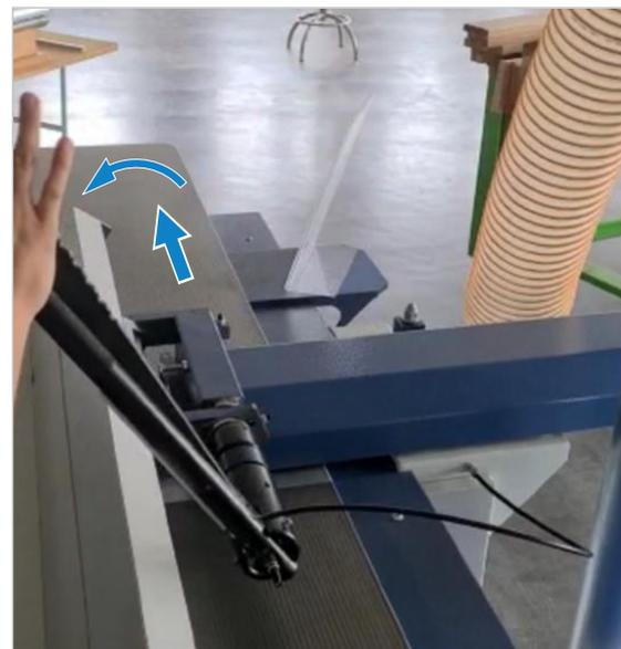
Figure 22 : régler l'angle de butée
