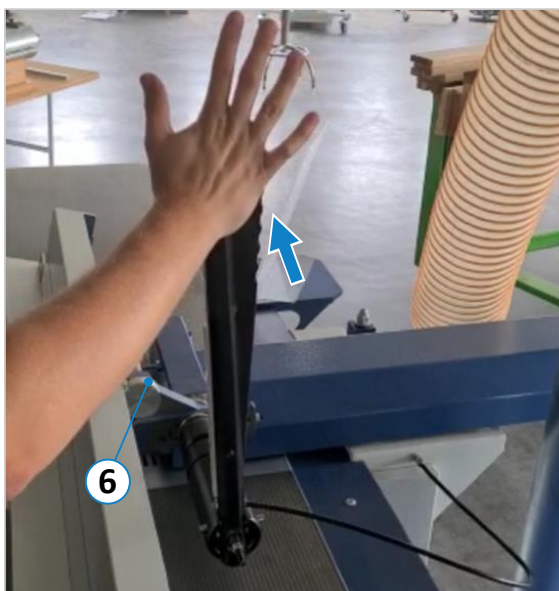
Figure 21 : activer le réglage angulaire de la butée
