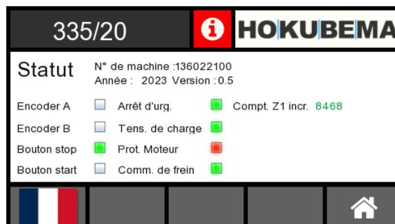
Figure 34: défaut de protection du moteur en cours
