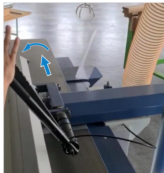
Figure 22 : régler l'angle de butée
