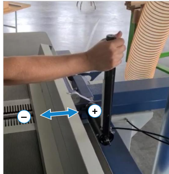
Figure 20 : régler la butée de manière linéaire
