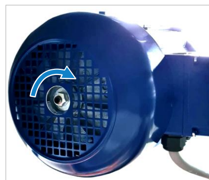
Figure 43 : réajuster le frein moteur
