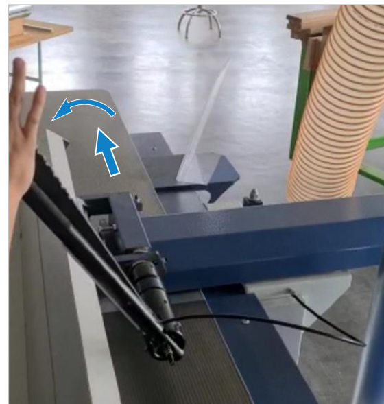
Figure 22 : régler l'angle de butée
