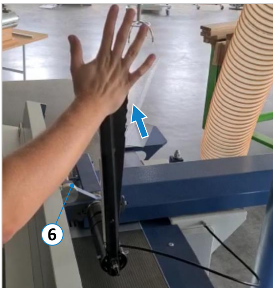
Figure 21 : activer le réglage angulaire de la butée
