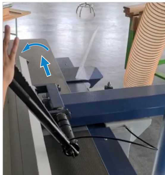
Figuur 22: De hoek van de aanslag instellen
