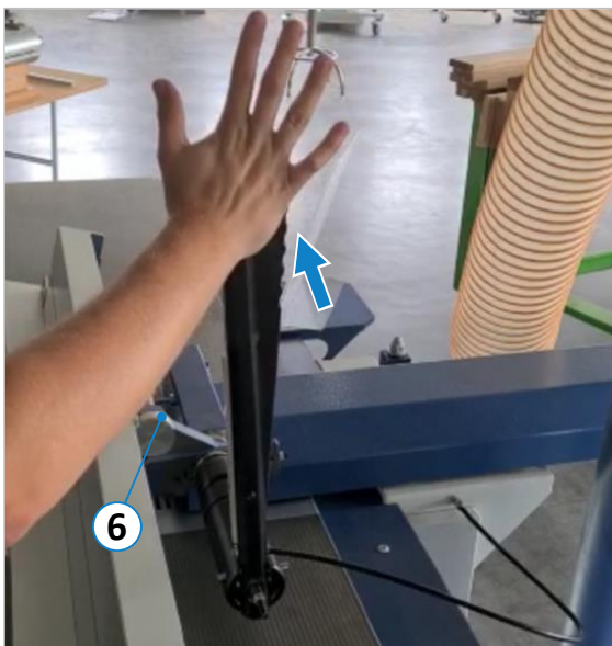
Figuur 21: Activeer de hoekinstelling van de aanslag
