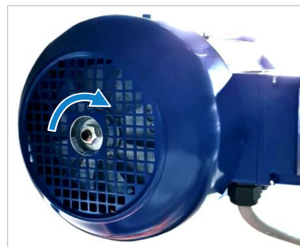
Figuur 48: Bijstellen van de motorrem
