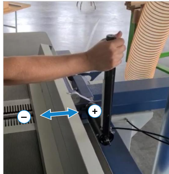
Figuur 20: Lineaire verstelling van de aanslag
