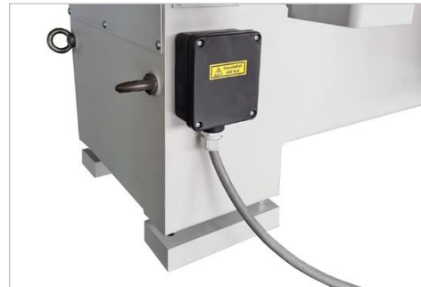
Figuur 11: Elektrische aansluiting
