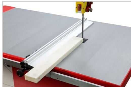
Figure 32 : réglage de la butée plat
