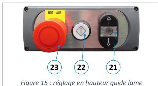
Figure 15 : réglage en hauteur guide lame
