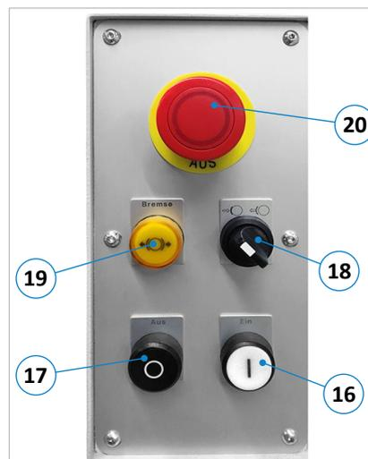
Figure 18 : panneau de commande (vitesse fixe)
