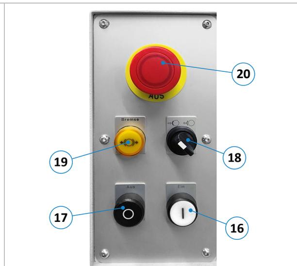
Figure 14 : panneau de commande (vitesse fixe)
