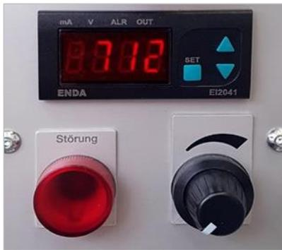
Les modèles à vitesse réglable en continu sont équipés d'un pupitre de commande modifié. Celui-ci comprend un potentiomètre de réglage supplémentaire pour régler la vitesse de la lame de scie d'env. 370 à 2000 m/min ainsi qu'un petit affichage numérique à LED sur lequel la vitesse peut être lue.
