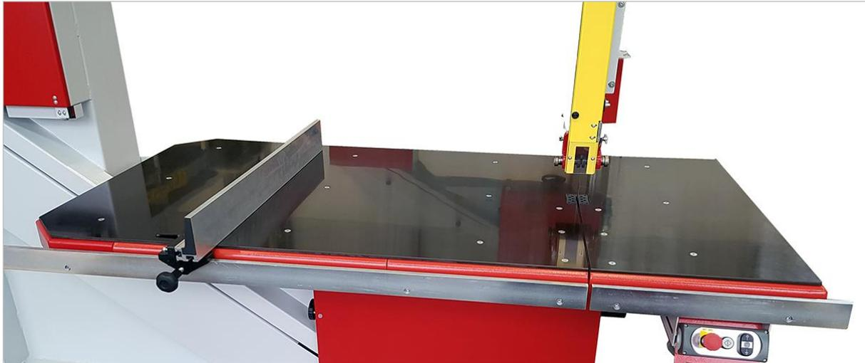
Figure 38 : plateau de machine en Pertinax® en option
