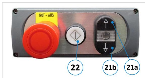
Figure 25 : réglage en hauteur du guide-lames supérieur
