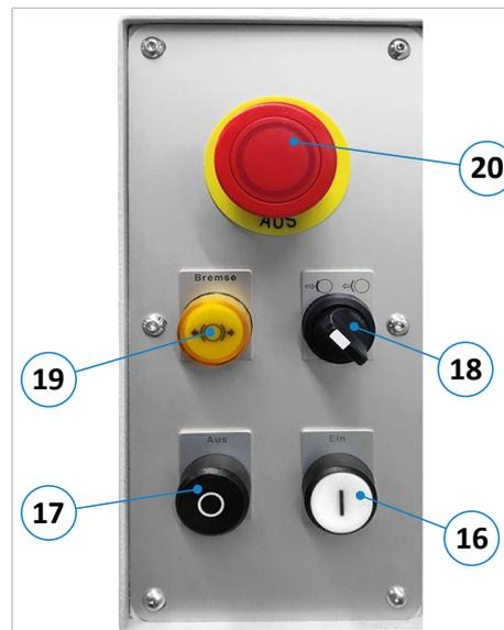
Figura 18: Painel de controlo (velocidade fixa)
