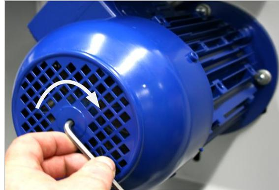
Figura 45: Reajustar o freio do motor
