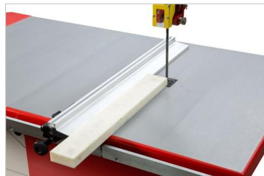
Figura 32: Batente paralelo para peças planas
