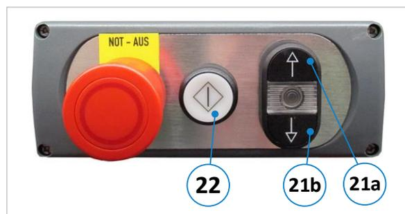
Figura 25: Painel de controlo para regulação da altura
