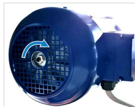
Abbildung 61: Motorbremse nachjustieren
