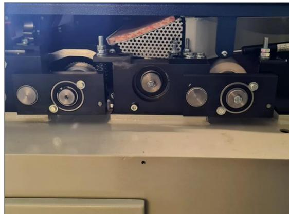
Abbildung 65: Gummiwalzentausch Schritt 1b
