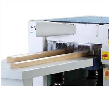
Abbildung 7: Absaugstutzen
