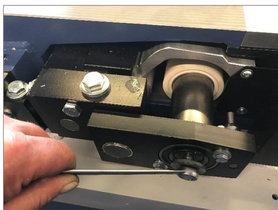
Figure 66: remplacement du rouleau en caoutchouc, étape 2
