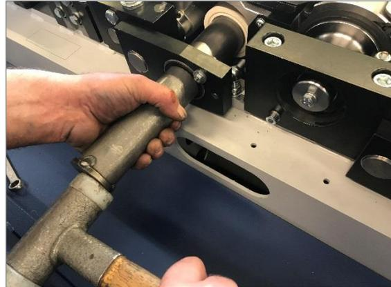
Figure 69: remplacement du rouleau en caoutchouc, étape 5b
