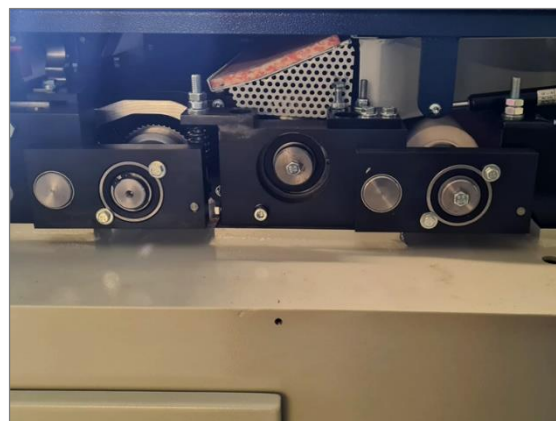
Figure 65: remplacement du rouleau en caoutchouc, étape 1b
