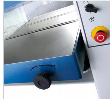
Figure 48: régler les rouleaux de table
