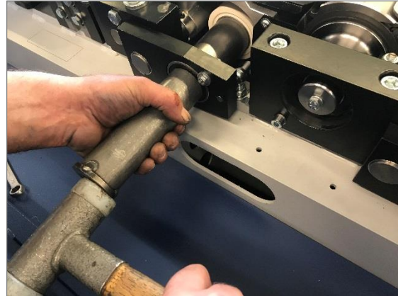
Figure 69: remplacement du rouleau en caoutchouc, étape 5b
