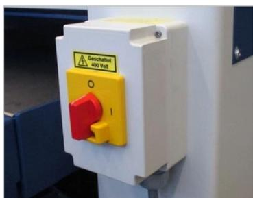
Figure 4 : interrupteur principal
