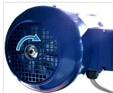
Figure 61 : réajuster le frein moteur
