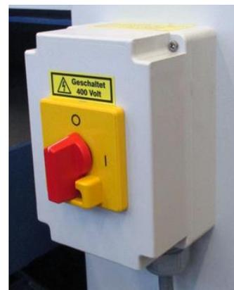
Figure 17 : interrupteur principal
