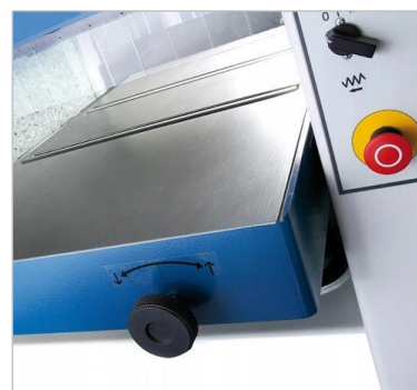
Figure 48: régler les rouleaux de table
