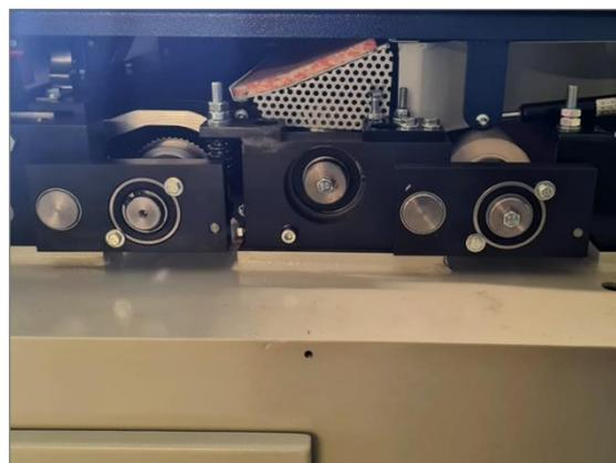
Figure 65: remplacement du rouleau en caoutchouc, étape 1b
