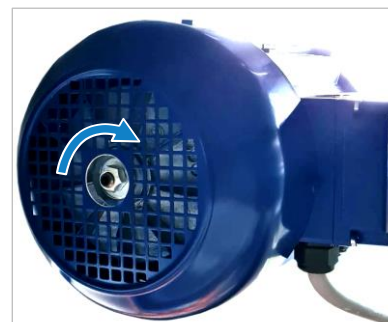
Figure 61 : réajuster le frein moteur
