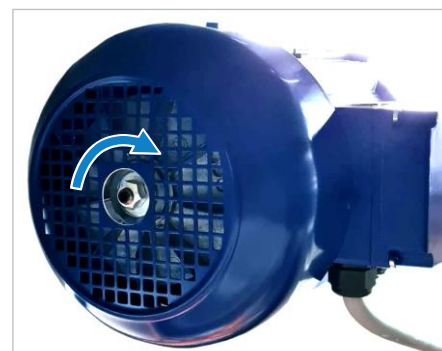
Figuur 61: Stel de motorrem opnieuw af
