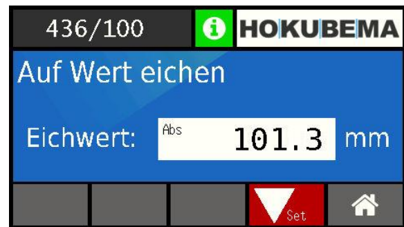
Figuur 33: Invoeren van de kalibratiewaarde
