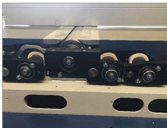
Abbildung 79: Gummiwalzentausch Schritt 1b
