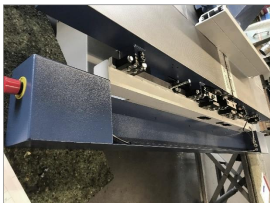
Abbildung 78: Gummiwalzentausch Schritt 1a
