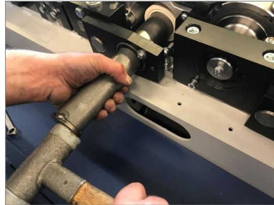
Abbildung 83: Gummiwalzentausch Schritt 5b
