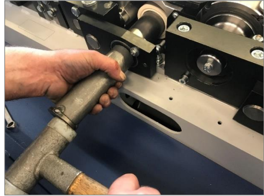
Figure 83 : remplacement du rouleau en caoutchouc, étape 5b
