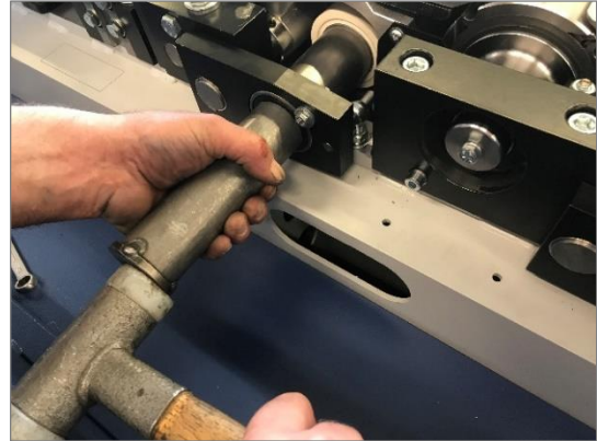
Figure 83 : remplacement du rouleau en caoutchouc, étape 5b
