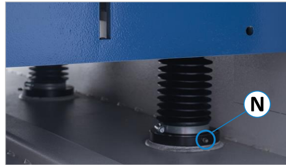
Figure 73 : graisseurs des broches de réglage
