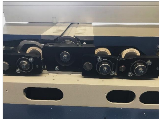
Figure 79 : remplacement du rouleau en caoutchouc, étape 1b
