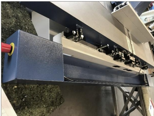
Figure 78 : remplacement du rouleau en caoutchouc, étape 1a
