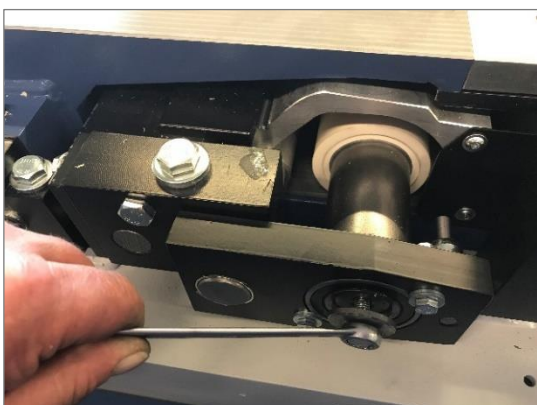
Figure 80 : remplacement du rouleau en caoutchouc, étape 2
