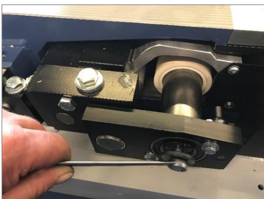
Figure 80 : remplacement du rouleau en caoutchouc, étape 2
