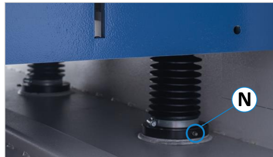
Figuur 73: smeernippels van de spindels
