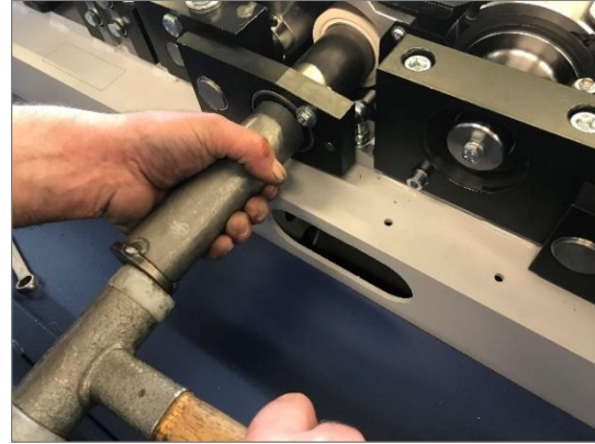
Figuur 83: Rubberrollen vervangen stap 5b
