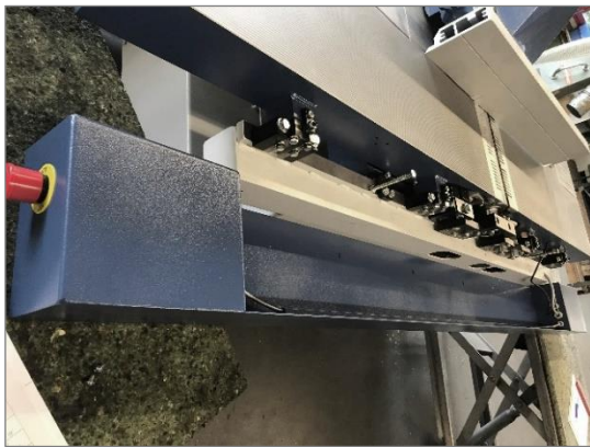
Figuur 78: Rubberrollen vervangen stap 1a
