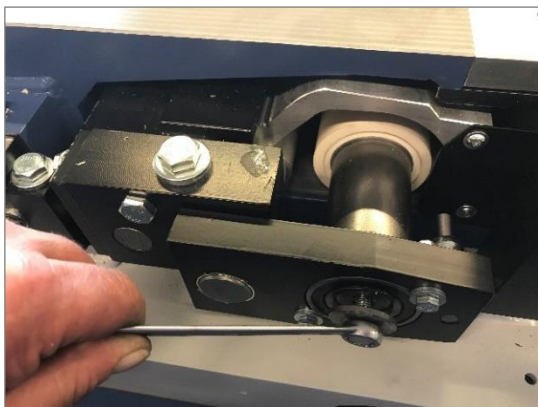
Figuur 80: Rubberrollen vervangen stap 2
