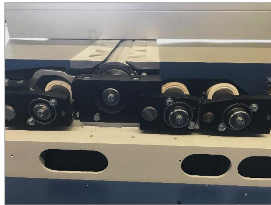
Figuur 79: Rubberrollen vervangen stap 1b
