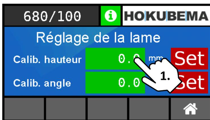
Figure 46 : calibrer la hauteur de la lame
