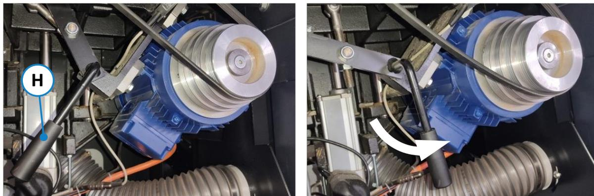
Figure 52 : réglage de la vitesse de rotation - desserrer la courroie trapézoïdale
