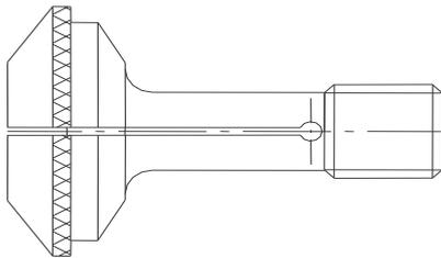
Figure 77 : vis de serrage rapide « Quickstep »
