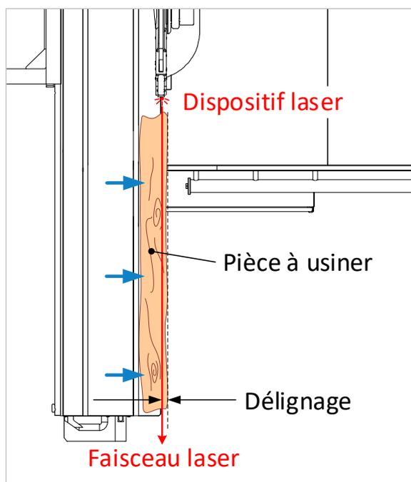
Figure 82 : délignage par faisceau laser
