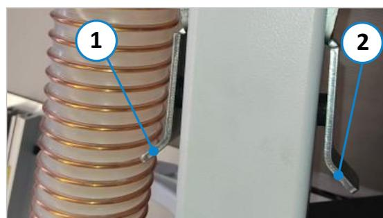
Figure 38 : bras pivotant pour capot de protection
