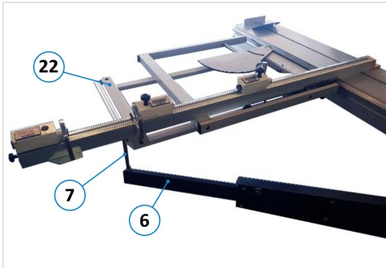
Figure 24 : montage du châssis à équarrir
