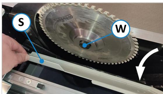
Figure 56 : rabattre le clapet à copeaux vers l'avant
