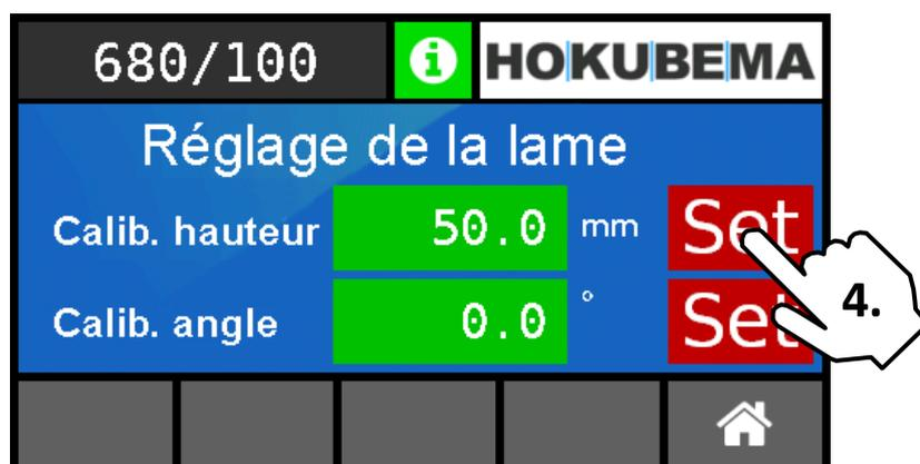
Figure 47 : reprendre la valeur de calibrage pour la hauteur
