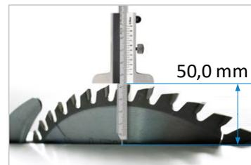
Figure 45 : hauteur de la lame 50 mm
