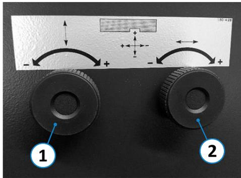
Figure 80 : roues de réglage pour inciseur
