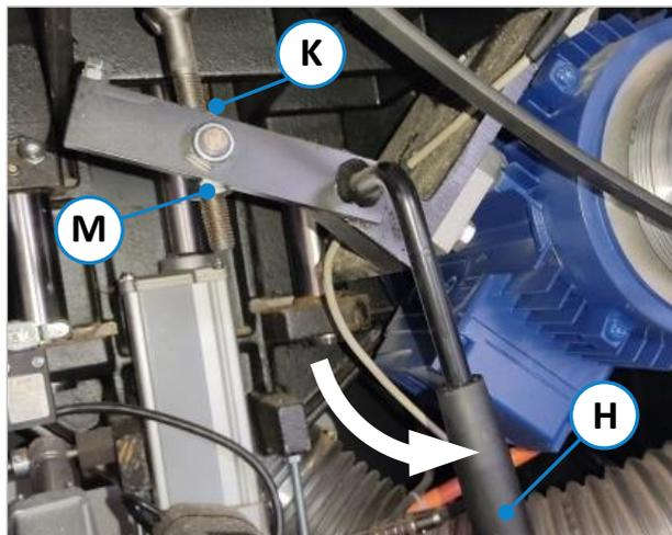
Figure 93 : tendre la courroie trapézoïdale
