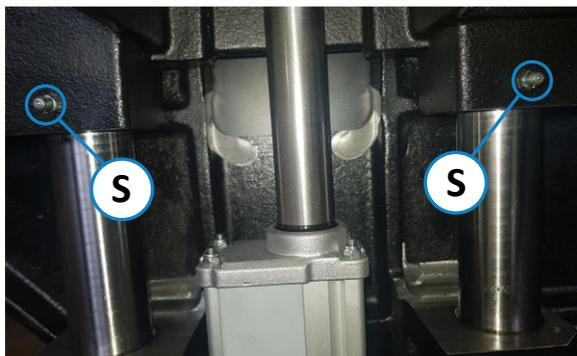
Figure 94 : points de lubrification sur le réglage en hauteur
