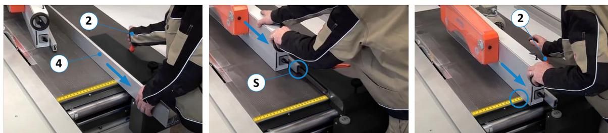
Figure 75 : monter l'appareil d'avance
