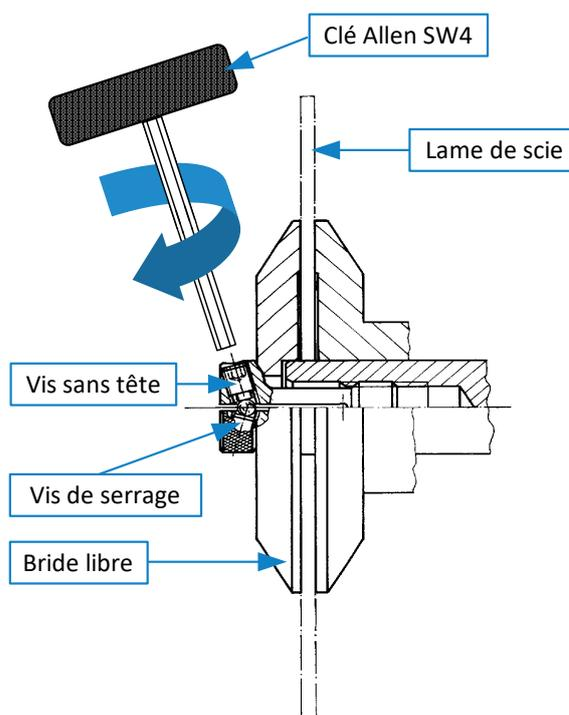
Figure 57 : bride de la lame de scie
