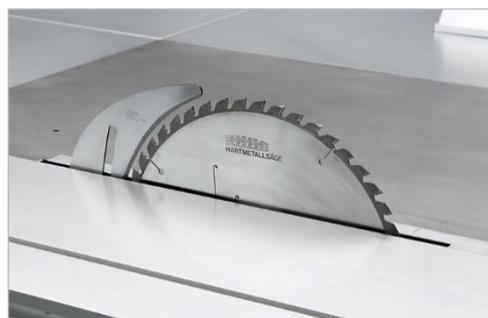
Figure 1 : lame de scie circulaire
