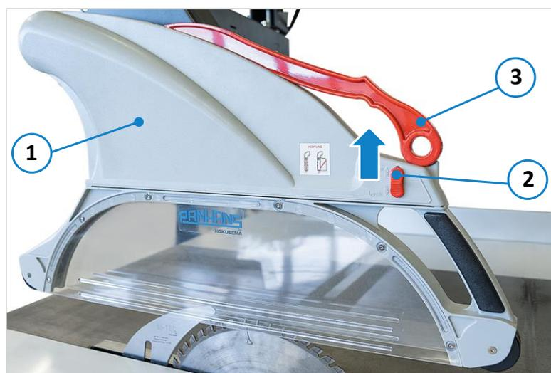
Figure 39 : monter le capot de protection
