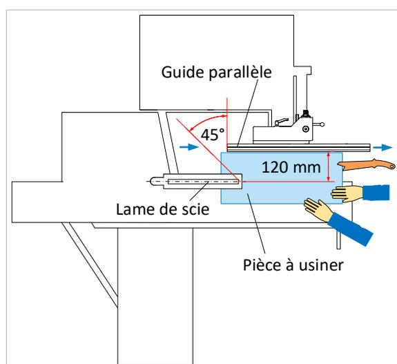
Figure 4 : découpe de pièces courtes sur la largeur
