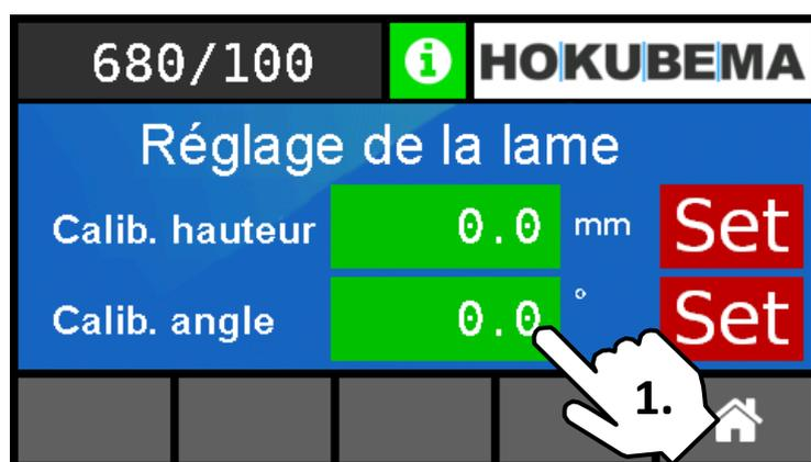
Figure 49 : calibrer l'angle de la lame
