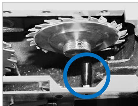
Figure 79 : cliquet d'arrêt du clapet à copeaux
