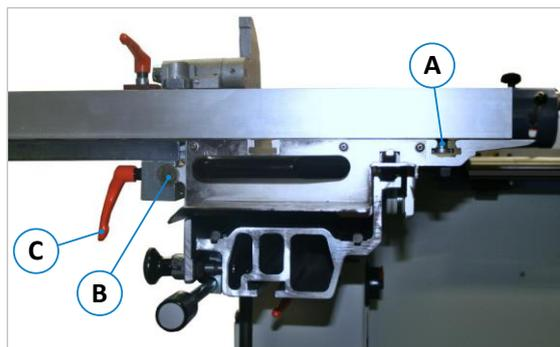
Figure 68 : structure du guide parallèle en option
