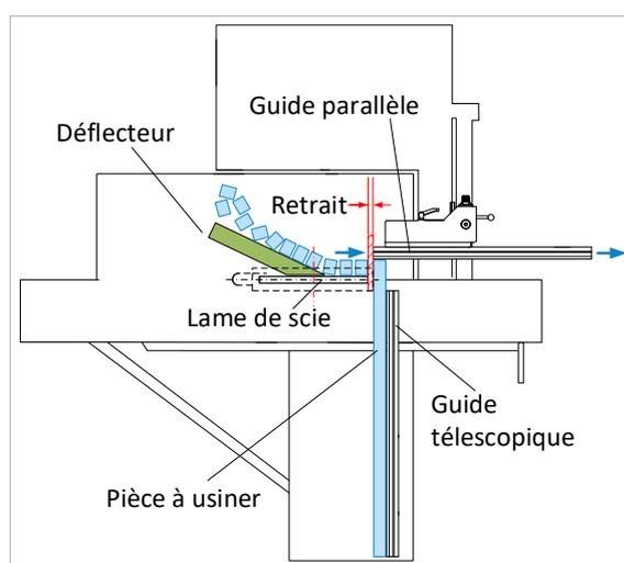
Si vous utilisez le guide parallèle pour couper de nombreuses petites pièces de dimensions identiques à partir d'une longue pièce (qui est en contact avec le guide télescopique), il faut éviter que les pièces déjà coupées ne se coincent entre la butée et la lame de scie et ne soient ainsi saisies par les dents montantes.
