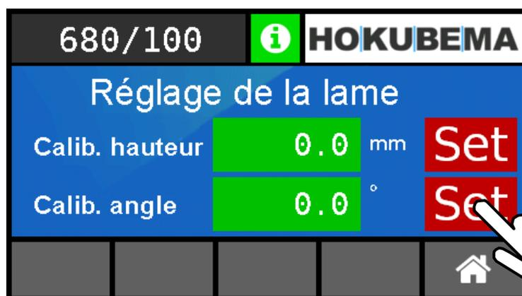
Figure 50 : reprendre la valeur de calibrage pour l'angle
