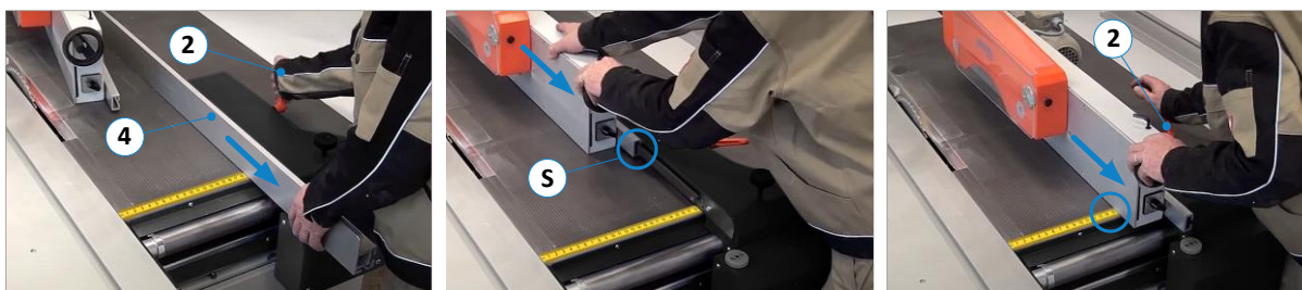
Figuur 75: Aanvoerapparaat bevestigen
