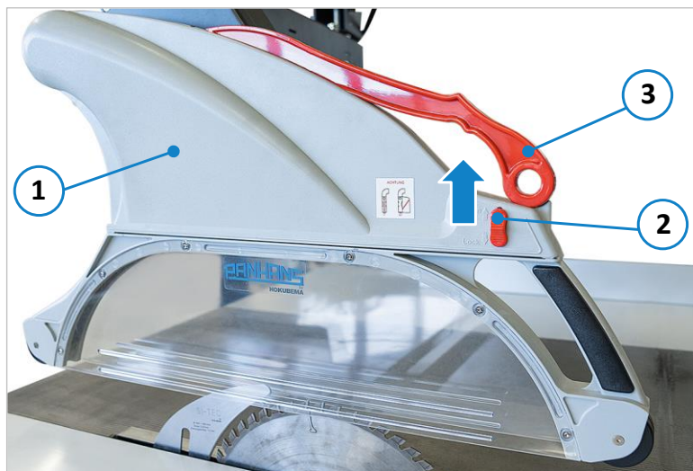
Figuur 39: Zaagkap vervangen
