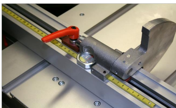
Figure 79 : butée à volet (à gauche de la lame de scie)
