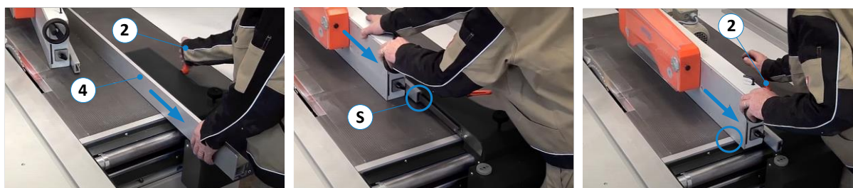
Figure 83 : monter l'appareil d'avance
