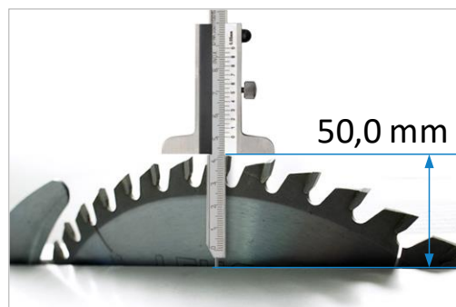
Figure 61 : régler la hauteur à 50,0 mm
