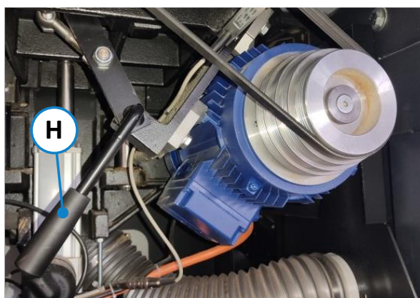
Abbildung 43: Drehzahleinstellung - Riemen lösen
