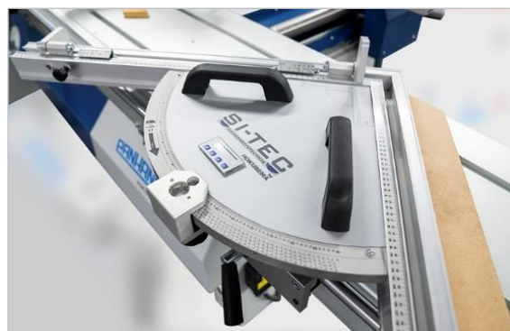
Figure 58 : DSG-D (avec affichage numérique)
