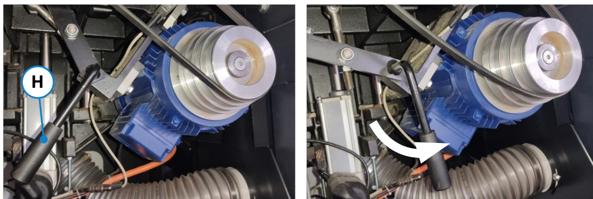
Figure 43 : réglage de la vitesse de rotation - desserrer la courroie trapézoïdale
