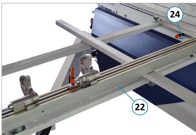
Figure 25 : déplacer les châssis à équarrir
