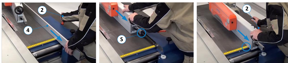
Figure 70 : monter l'appareil d'avance
