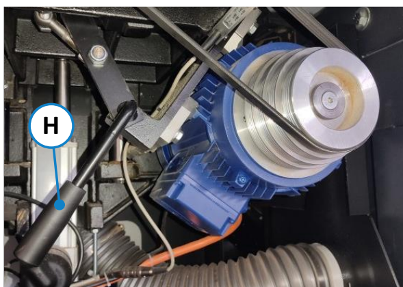
Figuur 43: Rotatiesnelheid aanpassen - riem losmaken
