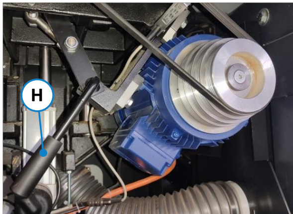
Abbildung 43: Drehzahleinstellung - Riemen lösen
